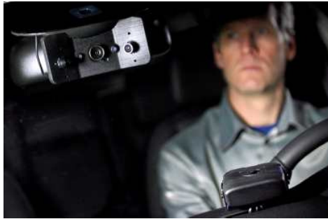
Bild: Björn Olsson Tre kameror sitter vid backspeglarna och en på instrumentbrädan. Bakom ratten Arne Nåbo som är ledare för projektet på Saab.
